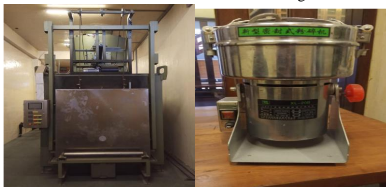
Gambar 2: Mesin krematorium dan Mesin Penghancur Tulang
