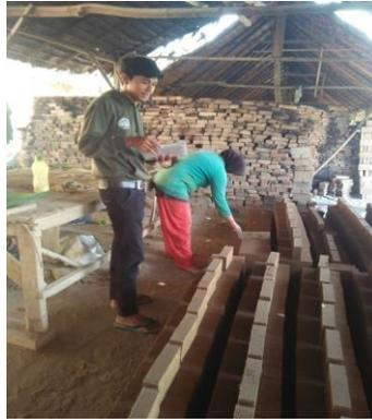
Gambar 3. proses pengeringan batu bata setelah dicetak
